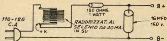
(A) ALIMENTATORE PER OSCILLATORE E UNITA' A 4 USI
