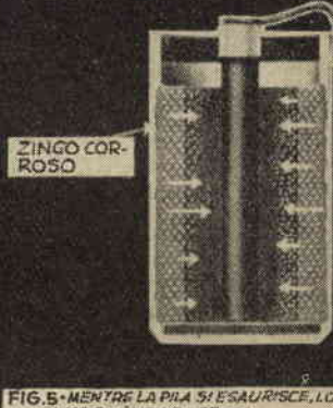
FIG. 5 - MENTRE LA PILA SI ESAURISCE, LO ZINCO PUO' VENIRE EROSO.
