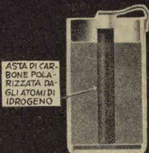
FIG. 3 - IL CARBONE GIUNGE A COPRIRSI DI IDROGENO TANTO CHE LA PILA NON PUO' FUNZIONARE.
